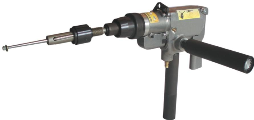
Специально разработаны для обеспечения единообразной развалцовки труб.
