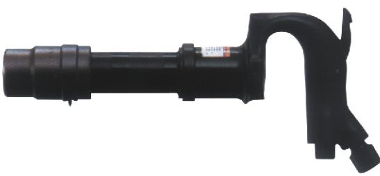
Пневматическое зубило, предназначенное для работы с инструментами для сминания и выбивания труб.
